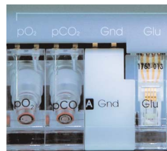
Cámara de medida
