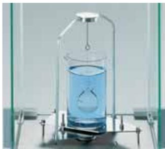
Especialmente fácil es la determinación de las densidades de líquidos con una probeta graduada.
