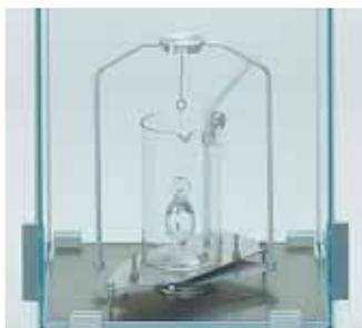
Empuje hidrostático, procedimiento de desplazamiento o el uso de picnómetro, para la determinación de muestras sólidas, pulverulentas o líquidas – Sartorius le ofrece el equipamiento técnico para todos los principios de medición.
