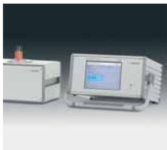
El **LMA300P** trabaja según la técnica de resonancia de microondas. En este procedimiento de medición indirecto se genera una microonda estática en un recipiente de muestra (aplicador). Si se coloca una muestra en el recipiente, el agua que allí se encuentra interfiere con el comportamiento oscilatorio (resonancia) de la microonda, y modifica por consecuencia la altura y el ancho.
