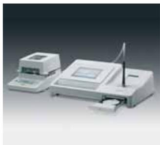
El LMA500 trabaja con métodos espectroscópicos, es decir, aprovecha de la interacción entre la muestra y la luz. Si se irradia luz del infrarrojo cercano (NIR), una parte de la luz se refleja y se modifica de manera característica por la interacción con la muestra. A partir de ese cambio de la luz NIR, el cual es dependiente del contenido de agua en la muestra, puede determinarse el contenido de humedad.
